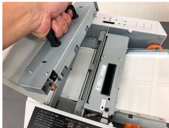
加圧ユニット取り外し
