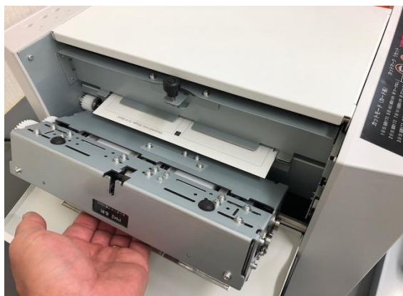
スリッターユニット取り外し
