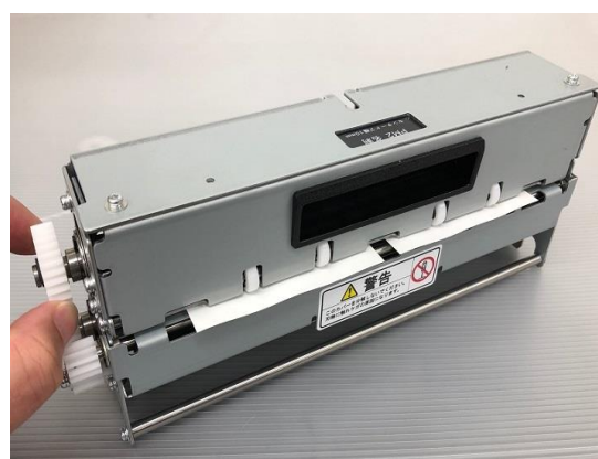
スリッターユニットの紙除去
